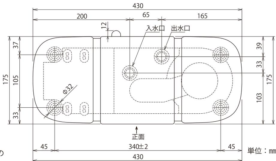
※寸法図は、CKV-232i、CKV-233FG、CKE-24HEの寸法です。他機種を設置の場合は、実測しご使用下さい。
